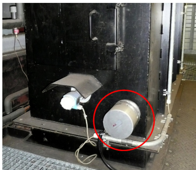
APOS Messkopf am Vorlagebehälter
